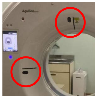
Fig.1 ガントリボア内上部と側面 2 箇所内に蔵されたカメラ
